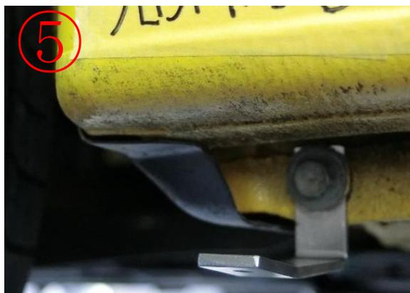
・車両リア側、サイドシル下部にある純正ボルトを外し、商品に付属の「R」と刻印のあるステーを外したボルトを使用し固定します。
