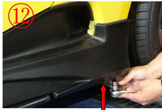
・フィンの出具合を調整します。任意の位置に調整し六角ねじを締め付け固定します。
