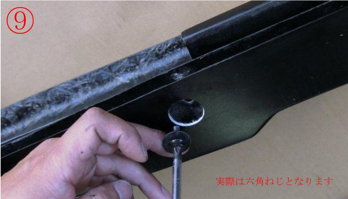
・サイドステップを車体に仮組みし、両面テープで車体に貼り付け、付属のボルトで先の手順で取り付けたステーに固定します。
